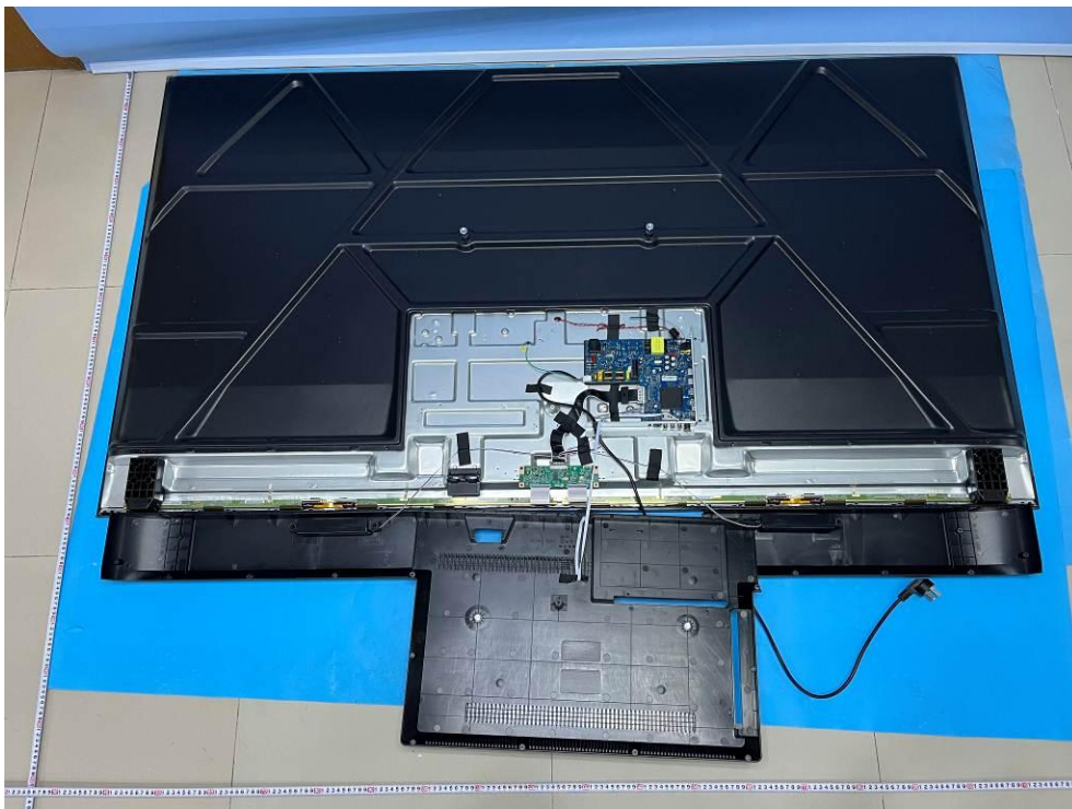
内部结构 (内部线材已用胶布固定)
